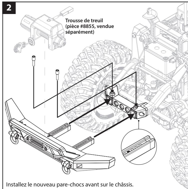
Installez le nouveau pare-chocs avant sur le châssis.
